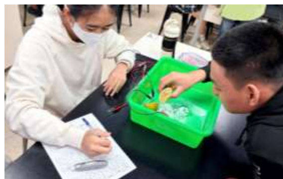
說明：進行各種化學電池測試並記錄電壓
