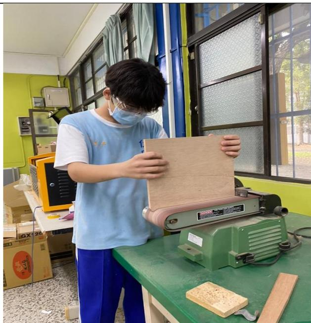
使用砂磨機研磨至平滑木材表面
