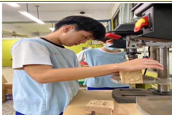
說明：鑽孔機操作
