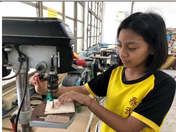
說明：學生在完成圖案及外形的吊飾木板上鑽孔，以便能穿鍊子
