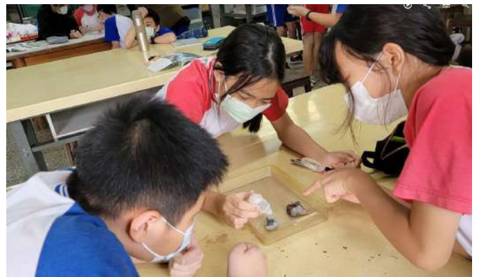
說明：滴檸檬酸在花崗岩和石灰岩上的實驗
