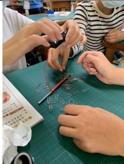
說明：各組操作電磁鐵如何吸起迴紋針。
