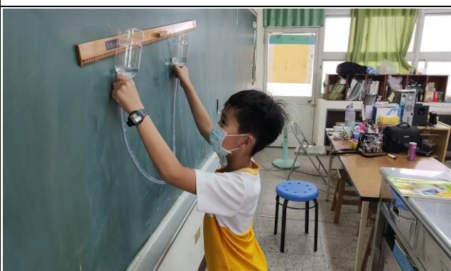
說明：利用連通管原理測量物體是否水平
