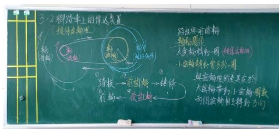
腳踏車傳送動力原理歸納
