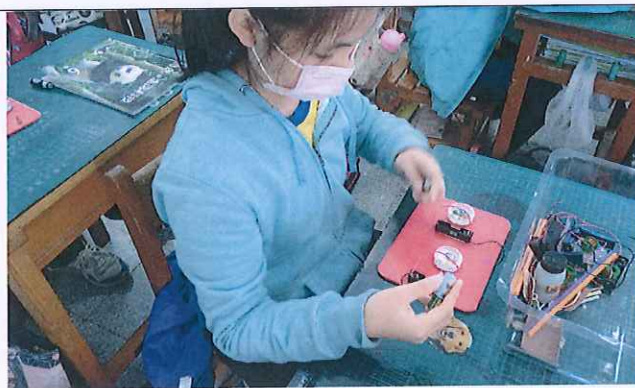
說明：電流方向相反，指北針偏轉的方向也相反
