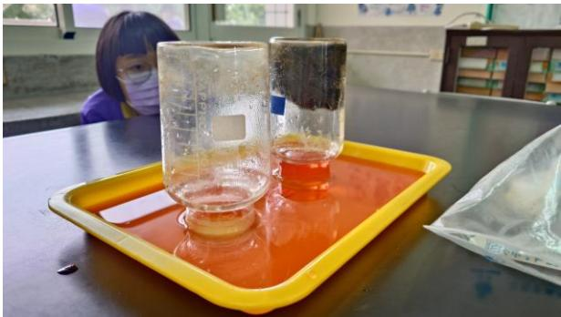
說明：鋼絲綿生鏽會耗損空氣中的氣體
