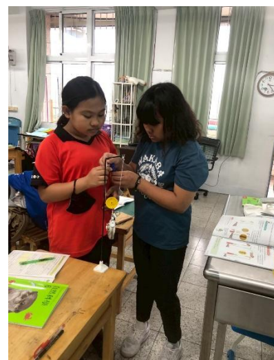
說明：操作-使用定滑輪和動滑輪，哪一種比較省力？
