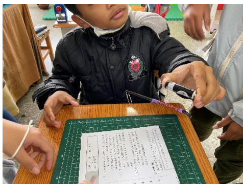
說明：簡易電磁鐵能吸起迴紋針
