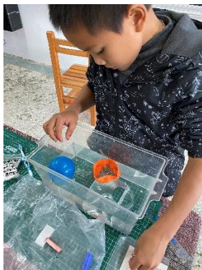
說明：用黏土捏成船形，測試能承載多少十元硬幣
